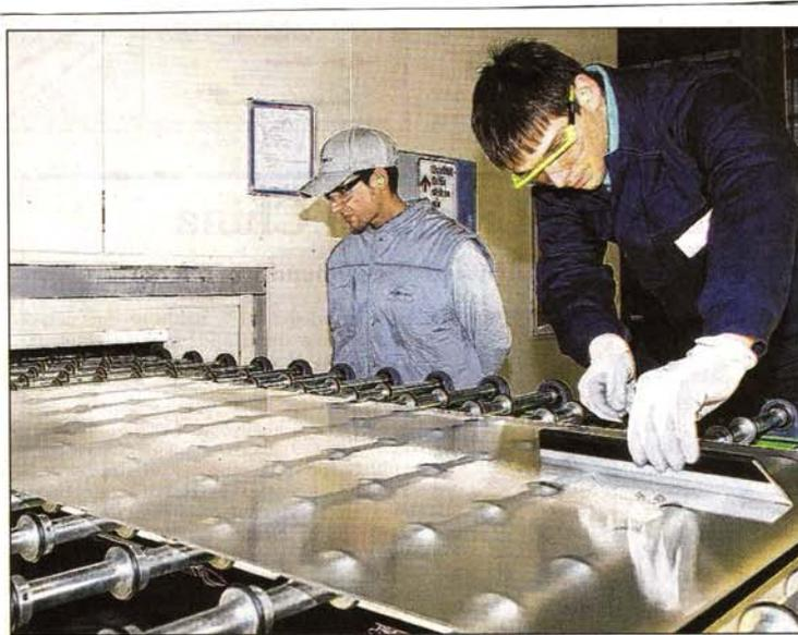
Das Albarino-Solar-Glas aus Luzenberger Produktion – extrem glatt, extrem lichtdurchlässig und mit einer Tragfähigkeit von bis zu drei Tonnen extrem belastbar. Bild: Proßwitz
